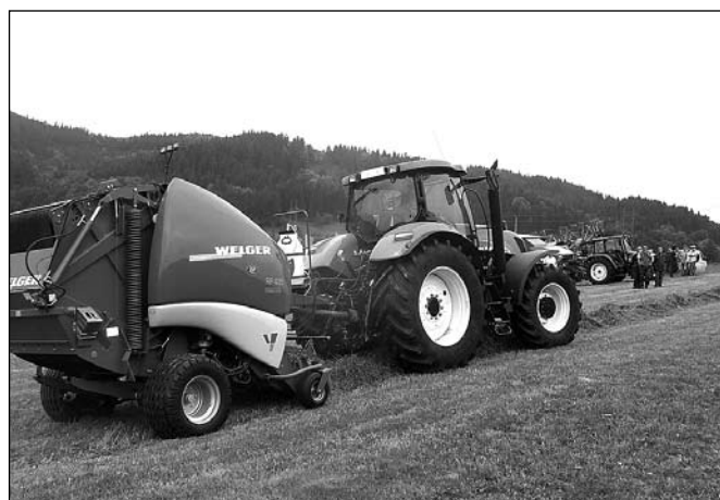
Svinovací lis Welger RP 435 lisuje balíky až do průměru 2 m
