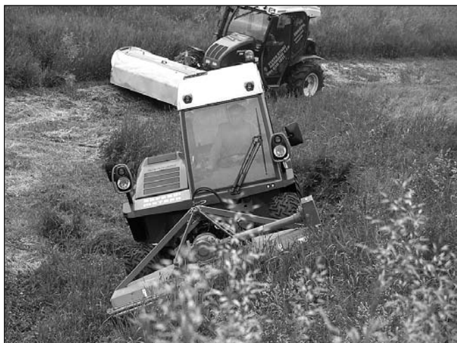
Nosič nářadí REFORM METRAC s žací lištou se svahovou dostupností až 40° při práci
