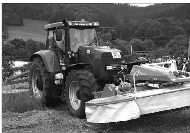
Novinka od firmy Pötinger, kombinovaná žací lišta NOVOCAT 306F \alpha -motion, dobře kopíruje terén
